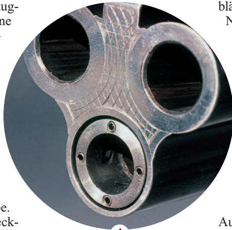
**Der Einstecklauf ist kürzer als der Schrotlauf, um sich beim Warmschießen ausdehnen und so die Präzision halten zu können. Mit den Innenschrauben wird justiert, außen liegen die Sicherungsschrauben.**
